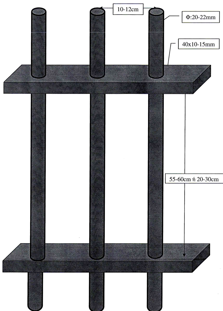
ΣΧΕΔΙΟ: Λεπτομέρεια Κατασκευής Κιγκλιδώματος
